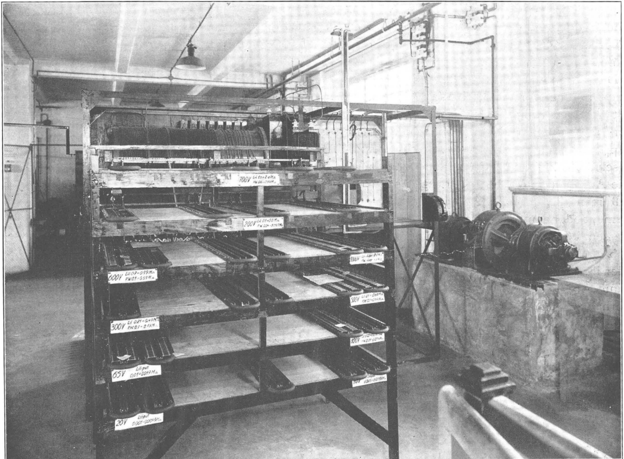
Abb. 3. Prüfstand für Hochfrequenzbelastung.
