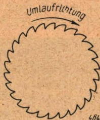
Abb. 11. Ermittlung des Umlaufsinnes der Zeitlinie durch Anlegen einer Kippspannung hoher Frequenz
