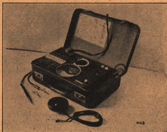
Abb. 1. Außenansicht des Koffers (links Buchsenfeld, Mitte: Instrument, dahinter Schleifdraht der Meßbrücke mit Buchsen für Kurzschlußbügel (Meßbereich-Umschaltung der Brücke); rechts neben dem Schleifdraht: Heizwiderstand des Röhrensummers (auch Tonhöhe) und Spannungsteiler ( \Omega -Eichung); — rechts hinten: Netz-Sicherungslämpchen, davor: Glimmlampe; vorn: Meßtaste der Brücke, Batterieschacht; ganz rechts: Zubehörfach mit Starkstromschnur. Auf der Frontplatte liegt der 3teilige Wanderstecker. Vor dem Koffer der Benaudihörer
