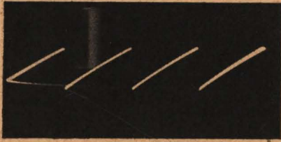
Abb. 13. Oszillogramm der Kondensatorspannung C_l in der Schaltung nach Abb. 12
